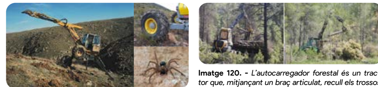
Imatge 119. - La retroaranya s'utilitza per a fer clots per a la plantació d'espècies forestals, en llocs de muntanya amb molt de pendent. El seu nom fa referència a una aranya, que avança alçant les potes del sòl. En la foto Lycosoides coarctata (Dufour, 1831). Disposa de 4 potes o braços, 2 amb rodes especials per a avançar per la muntanya sense arrossegar el sòl i xafar la vegetació. Font: Ministeri i GVA.
