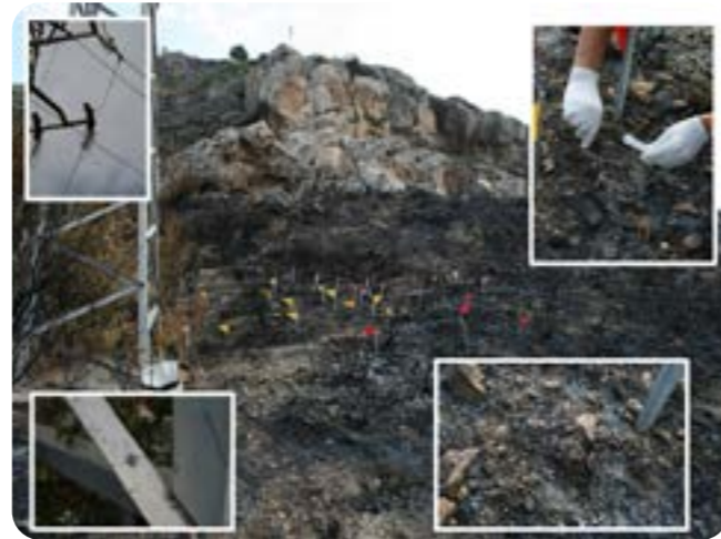
Imatge 162. - Incendi forestal a causa d'accident (trençament de cable elèctric). Font: GVA.
