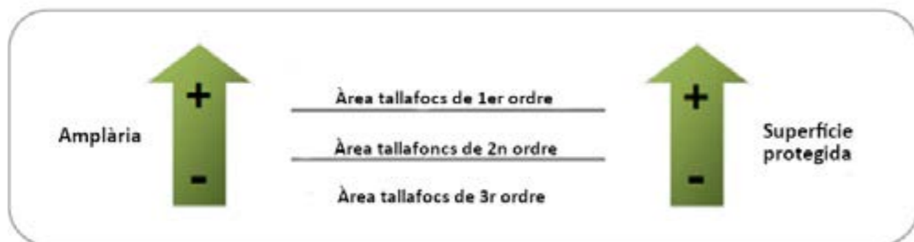
Imatge 178. - Les masses forestals extenses es fraccionen amb una xarxa d'àrees de tallafocs, segons ordres d'importància o magnitud (primer, segon i tercer ordre). Font: GVA.
