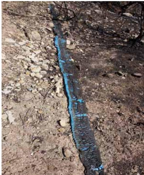
**Figura 4.** Detalle de conducción de agua quemada.
