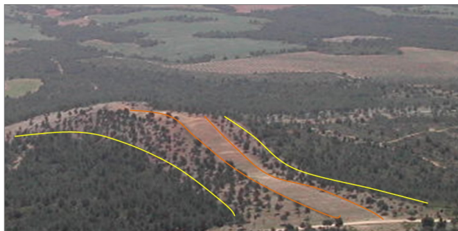
Área cortafuegos apoyada en cortafuegos existente. Antiguo cortafuegos en naranja y banda auxiliar en amarillo.
