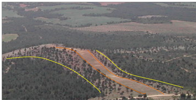
Àrea tallafocs recolzada en tallafocs existent. Antic tallafocs en taronja i banda auxiliar en groc.
